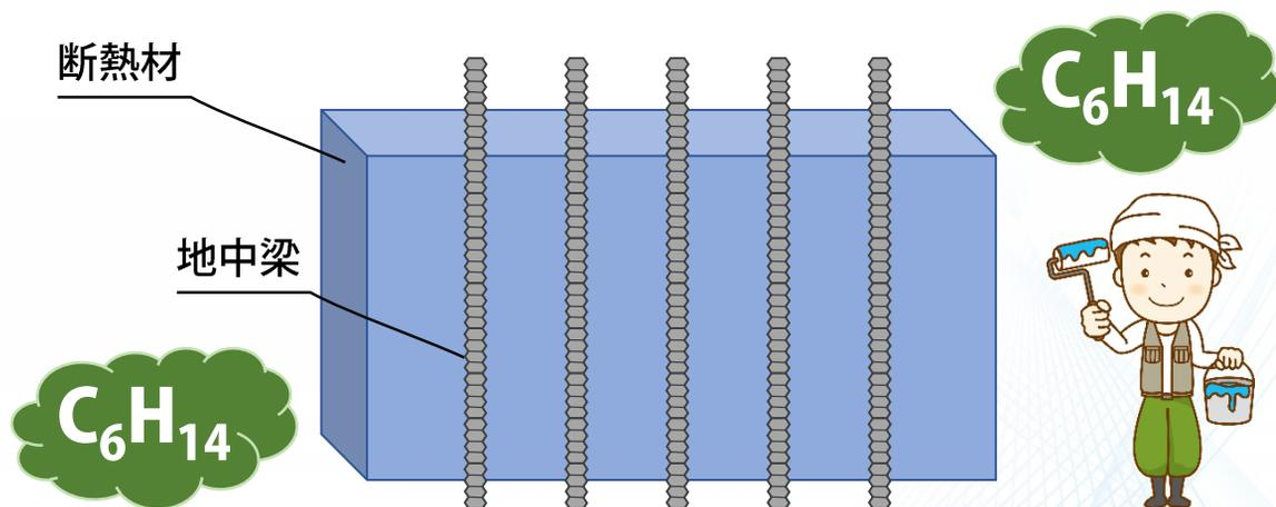
建築工事において、発泡ウレタンなどからなる断熱材を地中梁の壁面に貼り付けるために、ノルマルヘキサン( $C_6H_{14}$ )などの溶剤を含む接着剤を使用することがあります。換気を十分に行わずに接着剤を使用すると、接着剤から気化した高濃度の有機溶剤(ノルマルヘキサンなど)の蒸気が床下部に滞留し、作業者が中毒を起こす可能性があります。このような中毒事故の防止に、ポータブルマルチガスモニター GX-6000 をご提案いたします。作業現場の有機溶剤の濃度を確認し、十分な換気や必要な呼吸用保護具を装着することにより、安全な環境下で作業を行うことができます。
